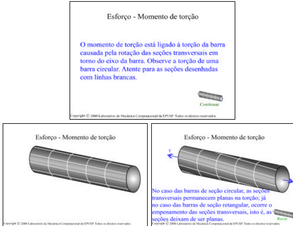
Figura 1 – Fases da animação referente à torção de uma barra (momento torçor)
